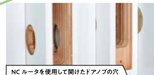
NC ルーターを使用して開けたドアノブの穴
