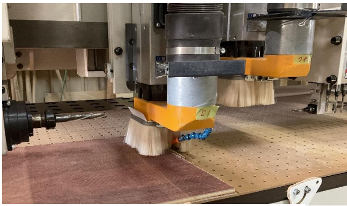
導入した NC ルーターで木材をカットする様子
