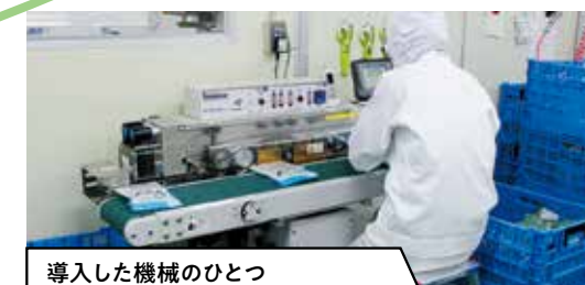
導入した機械のひとつ サーマルプリンター搭載型ソール機
