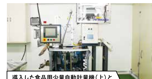
導入した食品用少量自動計量機(上)と 小型縦ピロ包装機(下)
