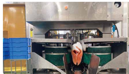
三枚卸機 ※頭を落とした魚体を通すことで、魚体を3枚に卸します。
