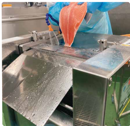
スキナー（皮を剥ぐ機械） ※3枚に卸した魚をセットすると皮を剥ぎ取ります。
