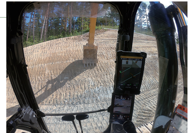
油圧ショベルの操縦席の様子。正面右手に備え付けられたモニターに、パソコンからの情報が送信される。
