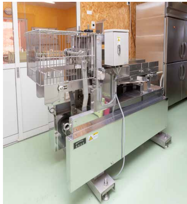
わかめの太茎を自動でカットする高速裁断機。
