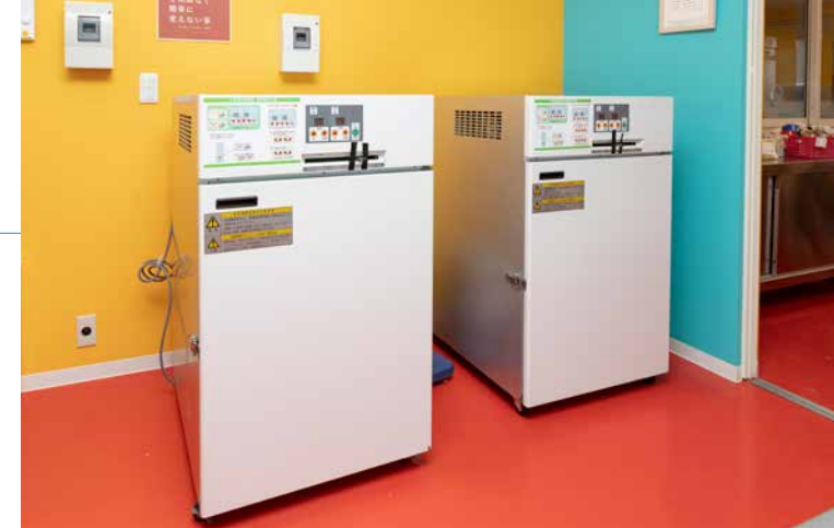
わかめの太茎をカット後、乾燥させるための電気食品乾燥機。従来の乾燥機と合わせて4台に。
