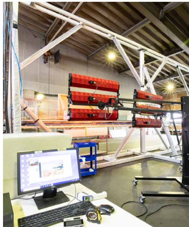
新たに導入したオートボディプリンター。フレーム脇にトラック等を駐車し、インクジェット方式で直接車体にプリントしていく。
