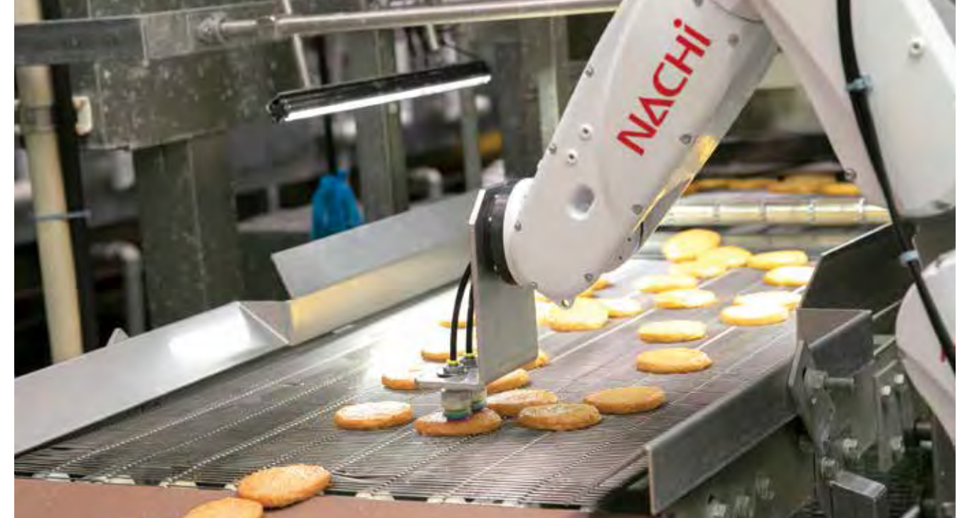
重なった製品を整える6軸多関節ロボット
