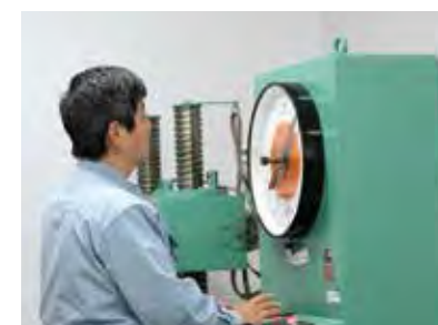
コンクリートの強度を検査する
