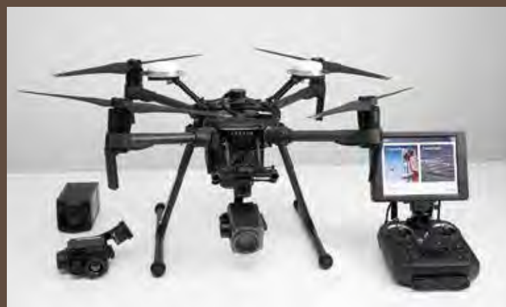
風力発電施設点検用のドローンとカメラ
