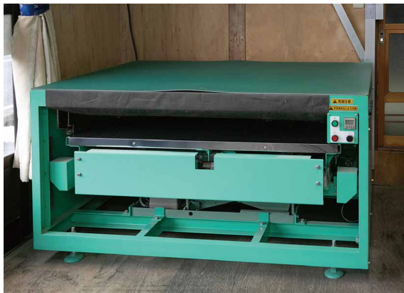
従来の畳製作の手法を覆す小型熱圧着機
