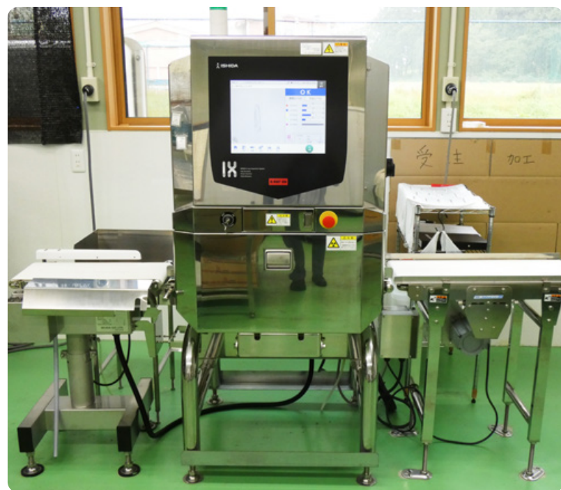
導入したX線検査装置
