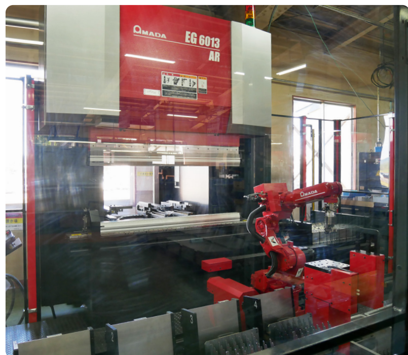
導入したデュアルサーボドライブベンダー（ロボットアーム付）
