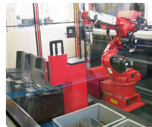
ロボットアーム部が金型と製品の両方を自動交換
