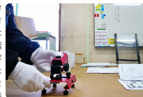
レーザー光線で倒木方向を示し安全な伐採作業を支援
