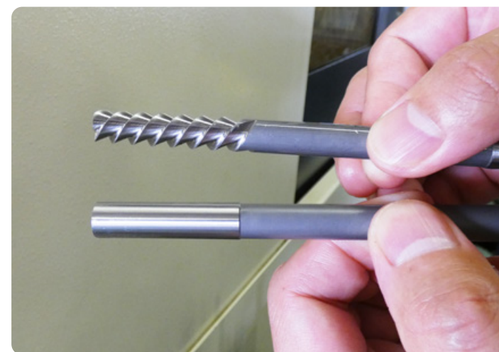
リーマ(太径)の研削例(下:研削前、上:研削後)
