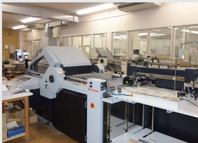
▲紙折機(菊全版)。自動化により調整時間が大幅に短縮された。
