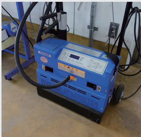
▲オパシメータ。ディーゼル車の排気ガスを計測。
