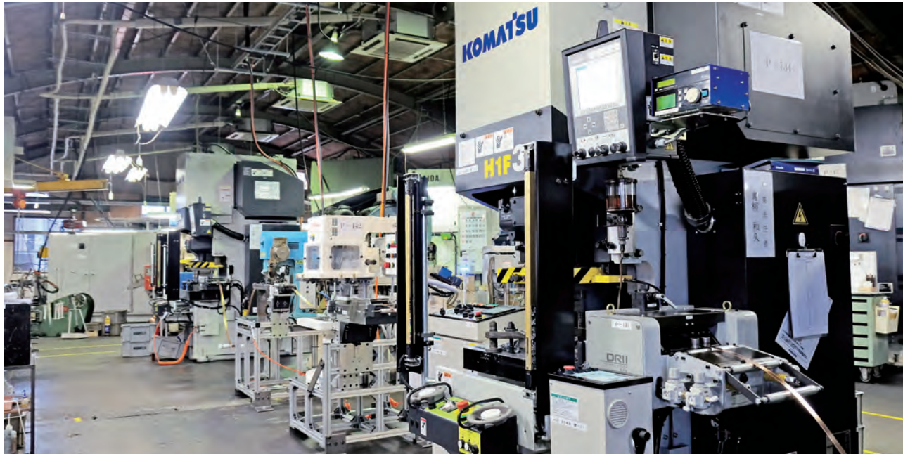
プレスとタップ加工を順送型で行う独自の自動プレスライン
