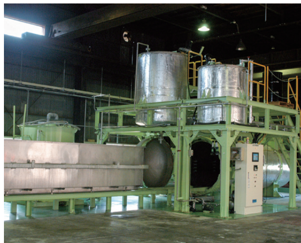
今回導入した真空加圧含浸装置。従来の装置と合わせ、発注に合わせて2基稼働させている
