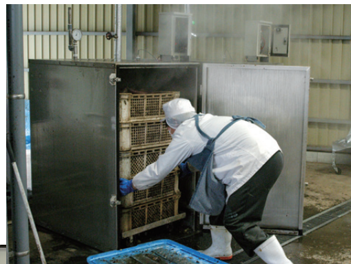
蒸かし庫は温度センサーに連動した電磁弁により、コンピュータ制御で庫内の温度を調整している。
