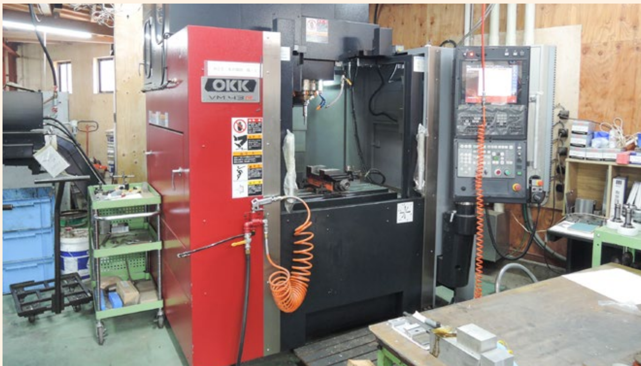
小型部品の小ロット加工に対応するために新たに導入した立形マシニングセンタ
