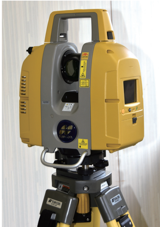
地上レーザースキャナー。ヘッド部分が回転し周囲の空間位置情報を大量の点群データとして取得する
