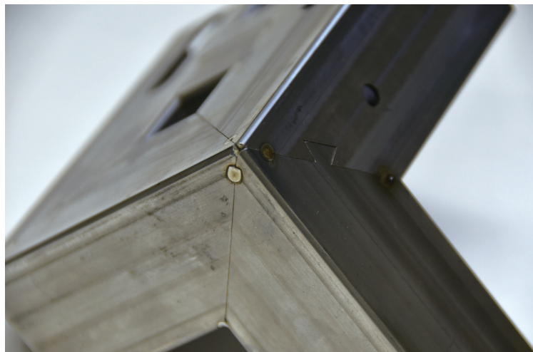
新型レーザー加工機で接合部を切断したフレーム材。右面には位置決めハブが刻まれている
