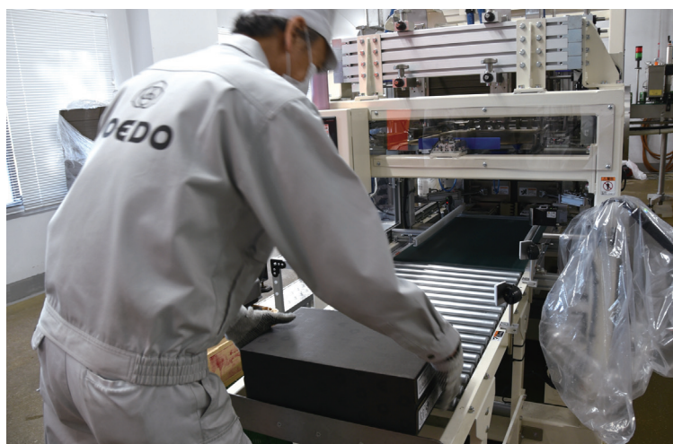
毎分70本のペースで充填される缶ビールを1箱24本ずつ自動で箱詰めするラップラウンドケーサー
