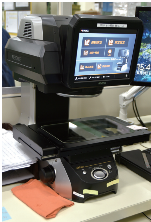
システムの核となるキーエンス社製の画像測定機
