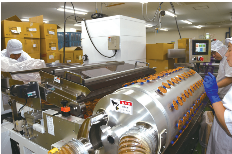
導入された横ピロー包装自動供給機。左側から自動投入されたせんべいがローラーの吸盤に吸い付き、右側奥の包装機へ流れていく
