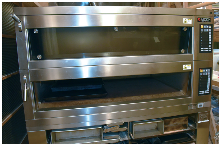
新導入したドイツ・ミベ社の大型オーブン。上段の窯に4枚、下に4枚と計8枚の鉄板を入れられる
