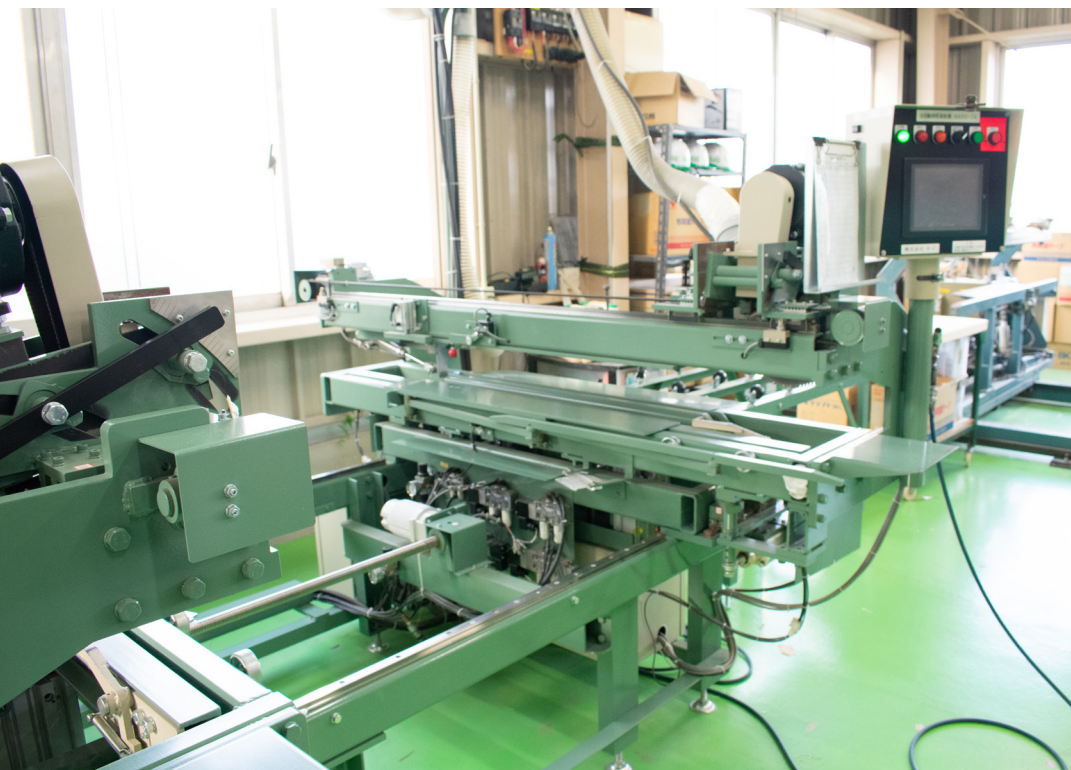
▲導入した自動チップソー裁断機
