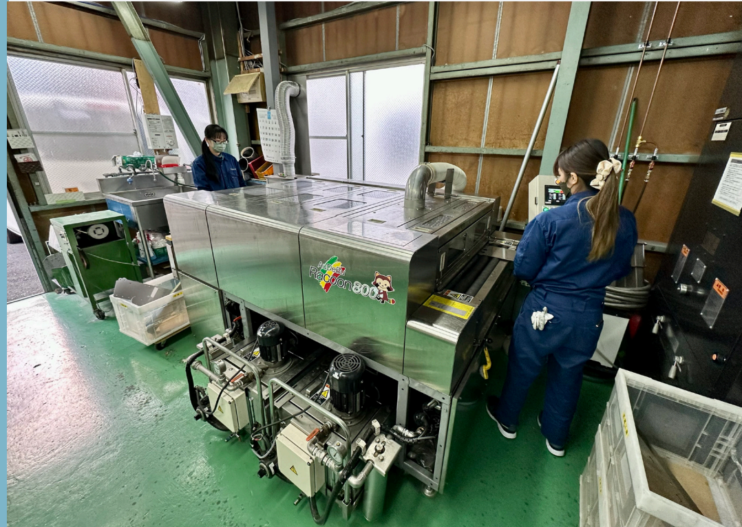
導入した板金用自動洗浄機
