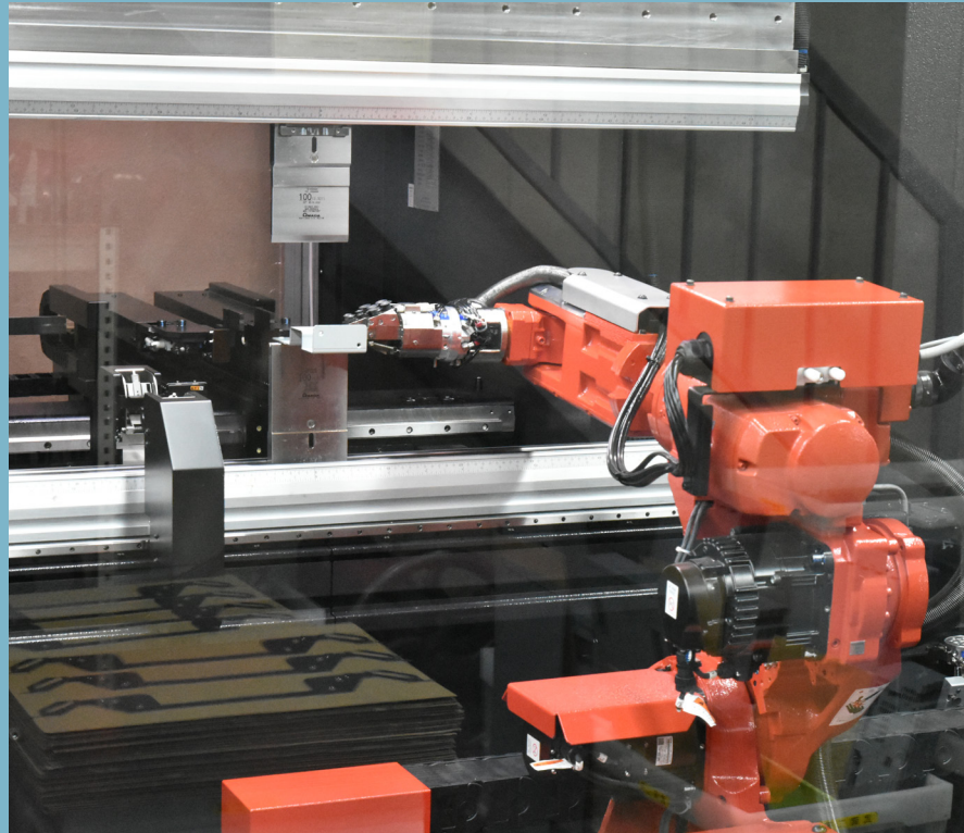
全自動曲げシステム 工場内のオートメーション化が進み24時間体制の加工も可能
