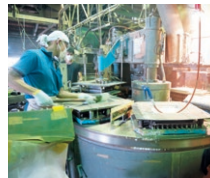
規格サイズのテラゾタイルの製造作業
