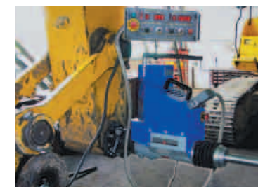
建機のオーバーホールで使用されるボーリングマシン。
