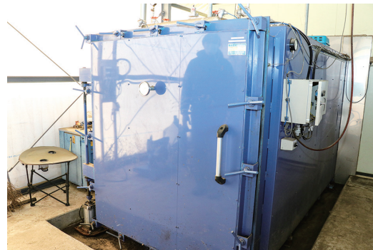
菌床玉を 500 個格納できる常圧殺菌釜
