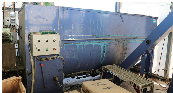
菌床培地の原料を混ぜ合わせる攪拌機
