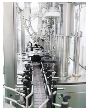
● 中央のレールに瓶を乗せるだけで洗浄、充填、打栓を行う
