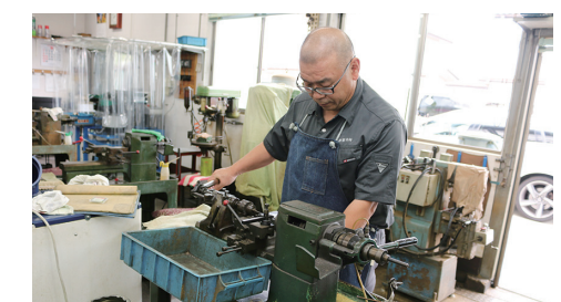
手加工の技術と経験が求められる旋盤を使った2次加工
