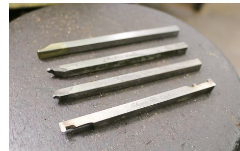
今村さんに使わなければならない手加工の素盤に刃物を研ぐ技術で、とても繊細な加工を必要とする材質の加工では、その刃物の研ぎ具合が出来を左右する。
