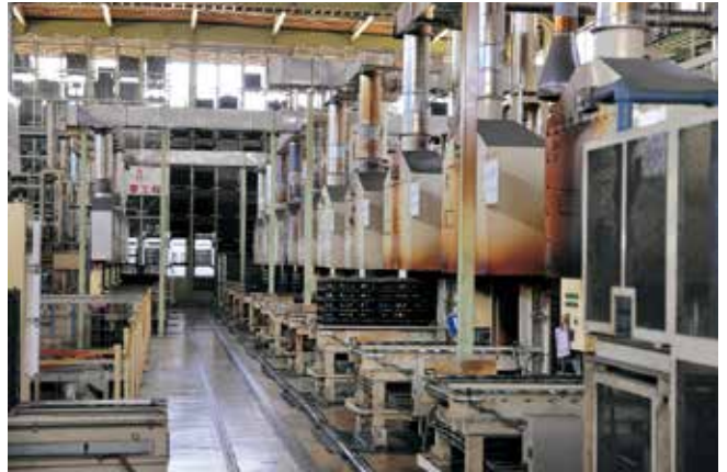
バッチ式浸炭炉ライン
