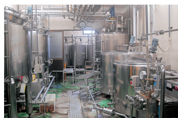
「無糖の飲むヨーグルト」専用の乳酸菌培養装置と発酵温度調整設備を設置した製造室
