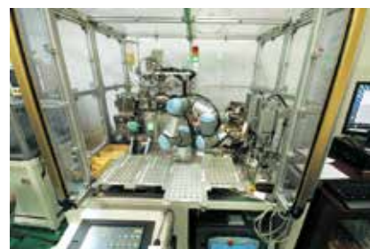
ドラム加工を自動化した専用機
