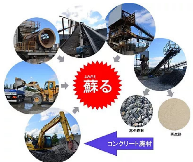
再生骨材製造プロセス
