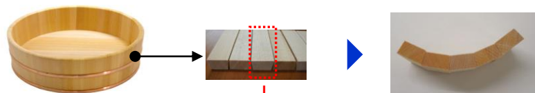
1枚の側板（くれ）を切出す作業
