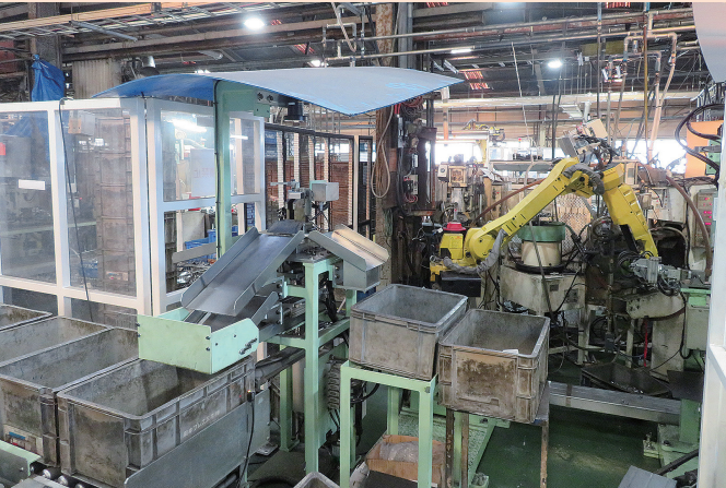
導入した溶接用搬送ロボット
