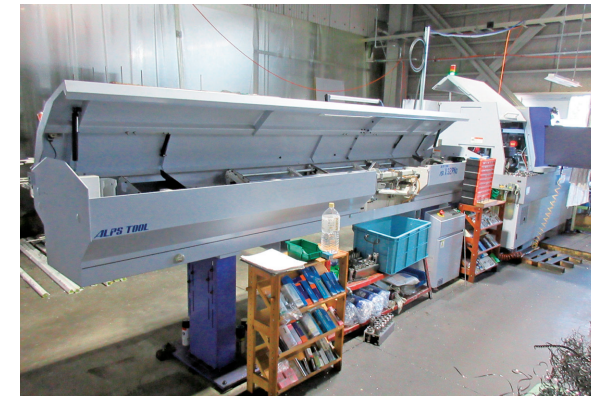
高硬度素材の加工が可能なNC旋盤
