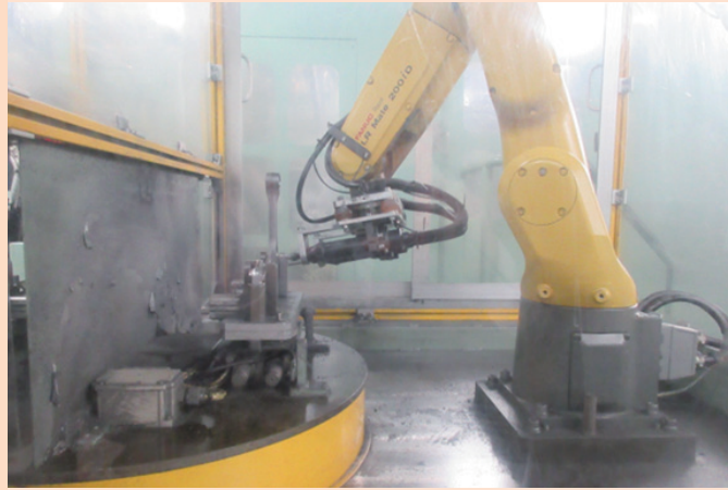
全自動バリ取り機による加工の様子
