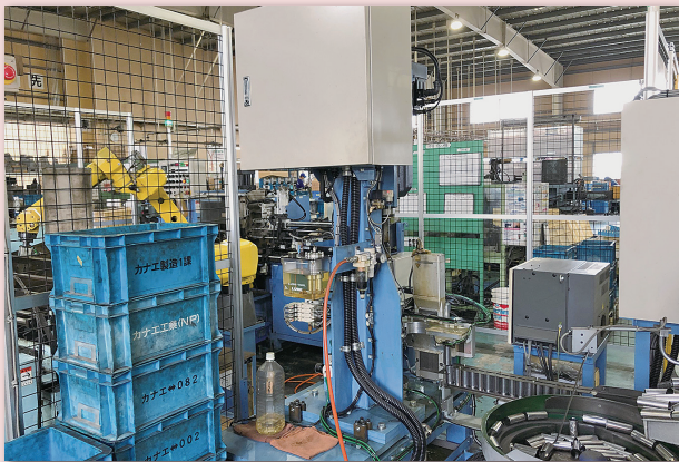
導入されたバニシング加工専用機
