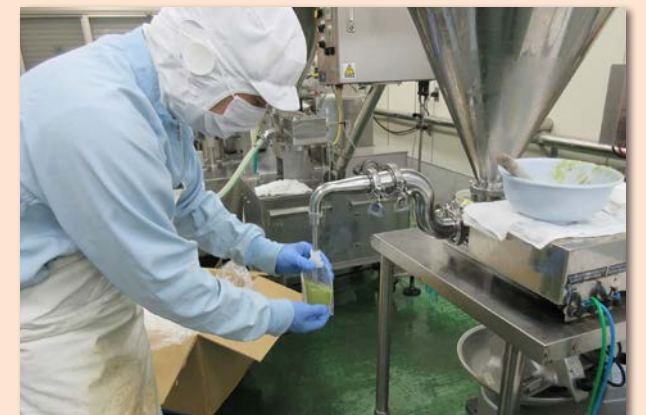
導入された充填機により、作業が半自動化された
