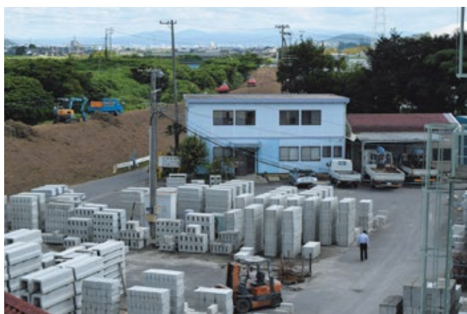
U字溝や集水桧などコンクリート2次製品を製造
