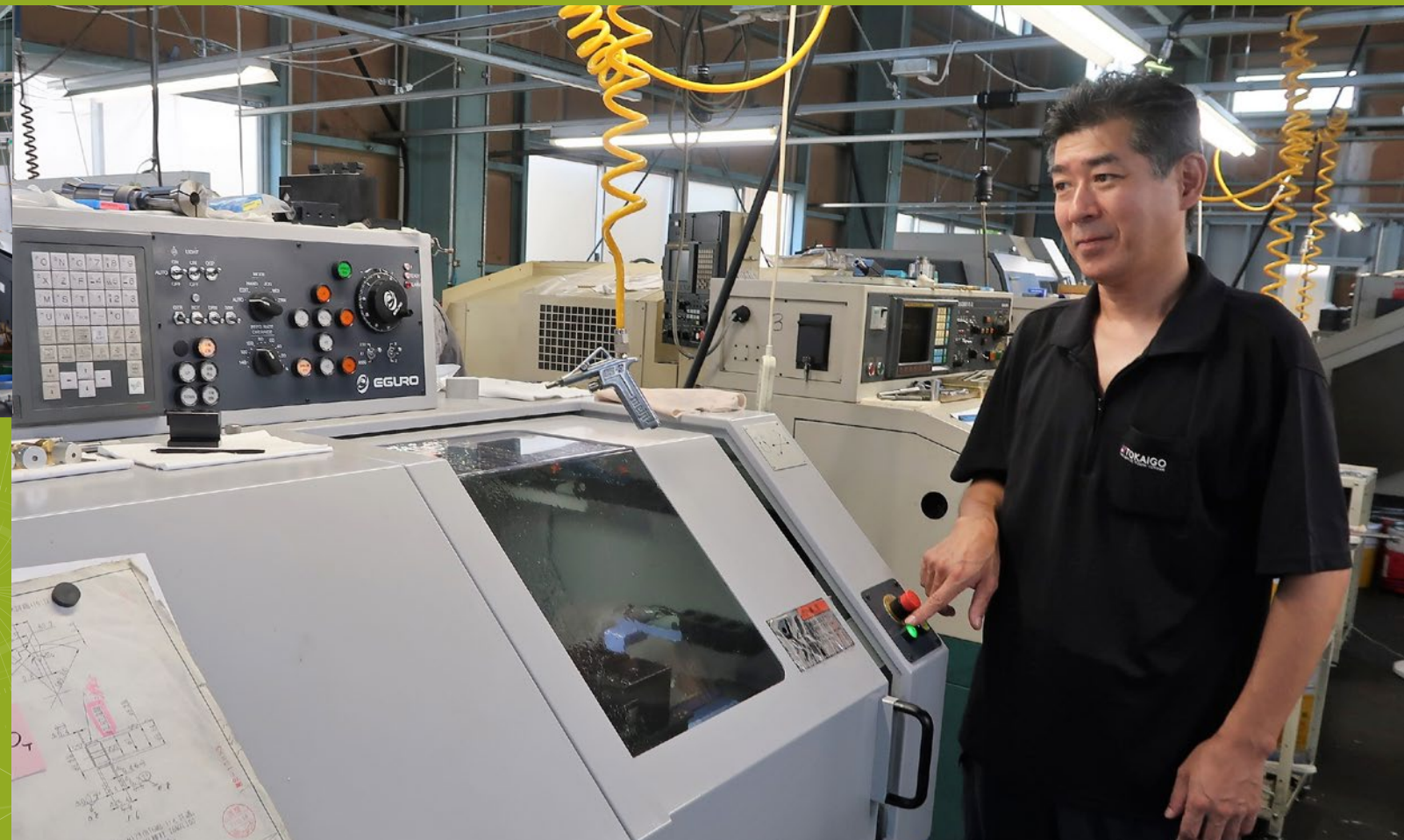
■ 加工精度±0.02ミリメートルを実現するNCローレット旋盤
