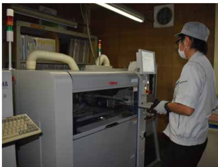
印刷から検査まで全自動化できるクリームハンダ印刷機
