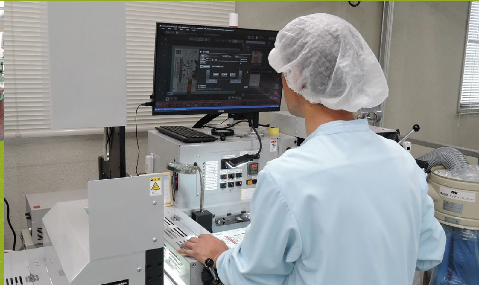
■ スリッター付き検査機の導入。切断と検査の工程を集約することで、生産効率を向上させた
