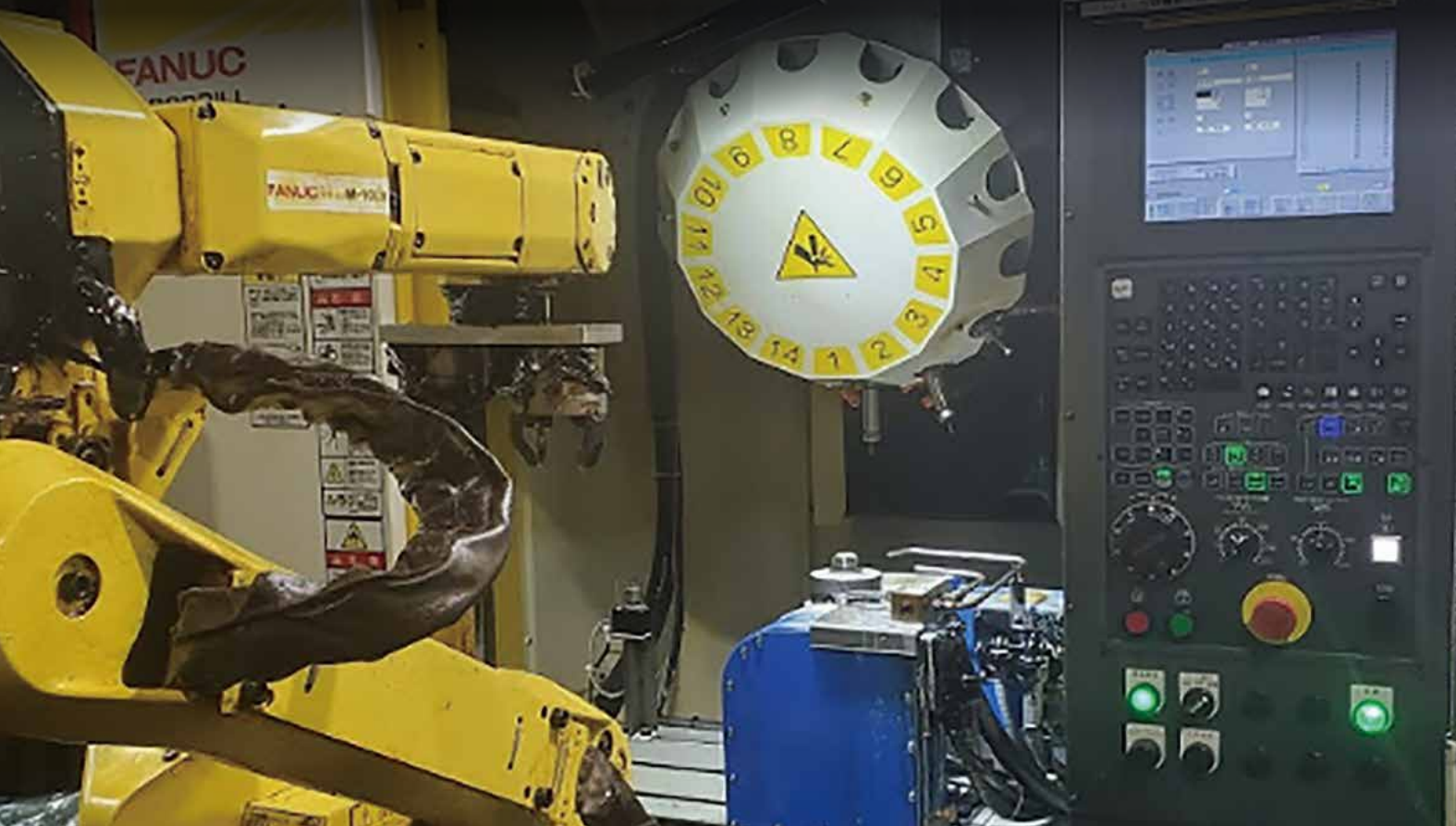
ロボドリル稼働中
