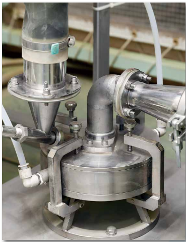
シングルトラックジェットミル： ミル（粉砕機）で空気の流れで8マイクロメートルといった微細な粒度にまで粉砕
