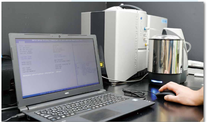
レーザー回折散乱式粒度分布測定器： 微粉末茶の粒度分布を測定し、平均粒度を算出
