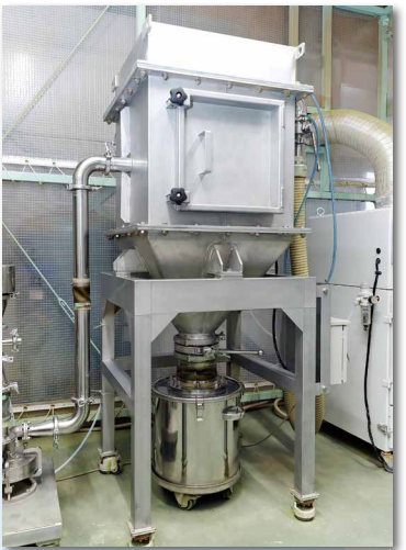
シングルトラックジェットミル： フィルターで微粉末茶と空気を分離
