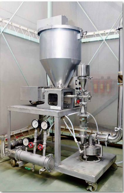
シングルトラックジェットミル： 上のタンクから原料茶葉を投入
