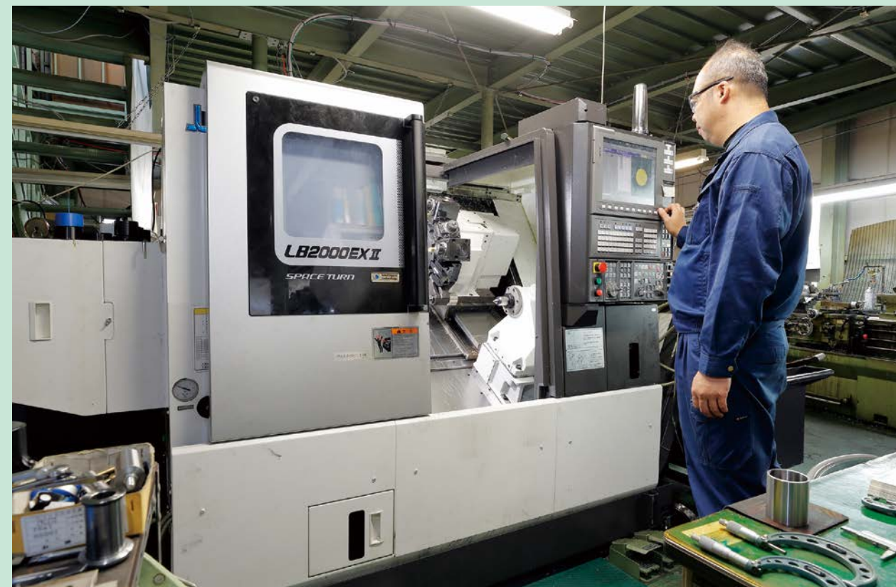
最新鋭のオークマ製複合加工機による加工の様子
