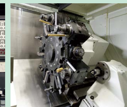
12本の工具を収納できる刃物台
